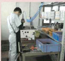
エアードライバーで給湯器本体から細かい部品を取り出し。
