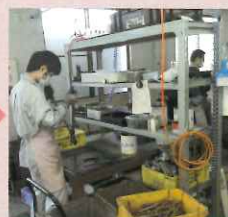
素材が異なる部分は大型カッターを使って切断。
